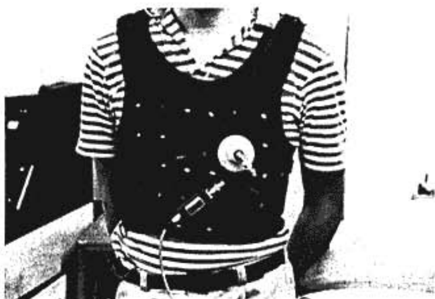
図1 携帯型左心機能連続監視装置 被検者が装着したチョッキに、左心室を照準するようにプローブを固定する。
